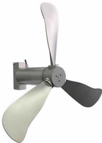
**QDTX型智慧潜水推流器**，是为高效智能化场境应用而设计的一款新型推流器。整机采用全不锈钢流线型设计，叶桨为冲压焊接成型，动力装置为高效行星齿轮和高效永磁电机，此外在电机腔内集成了智慧型驱动控制器，可实现旋向识别、过载调整、无极调速和信号传输等功能。
